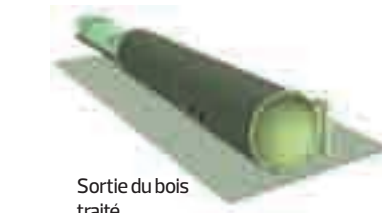
Injection du traitement sous pression
